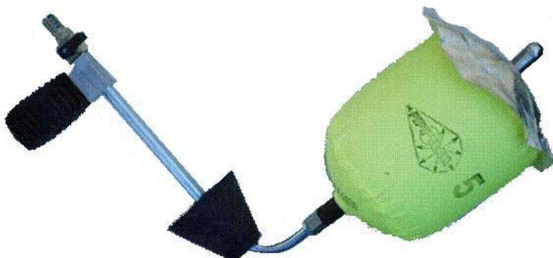
Palloni otturatori per basse pressioni, con calotta protettiva anticalore in fibra di vetro alluminizzata sia sul lato anteriore, montato su tubo zincato fino Ø 175, con camera d'aria, fodera in poliestere gommato antistatico, tappo conico scorrevole in gomma. Completo di manometro con protezione in gomma e quadrante con indici delle pressioni di gonfiaggio (dal Ø 50 a Ø 1000).
